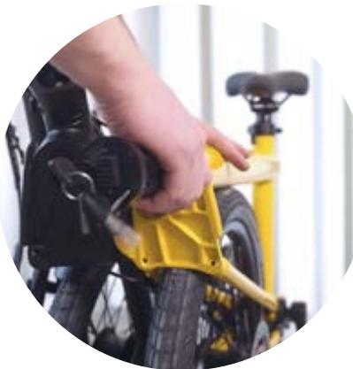
**Akku laden:** Vorderrohr aufklappen, Akku aufschliessen und herausziehen.
