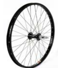
9376, 20 x 1-3/8" (451), Stummelachsrad, Achse Ø 12 mm
